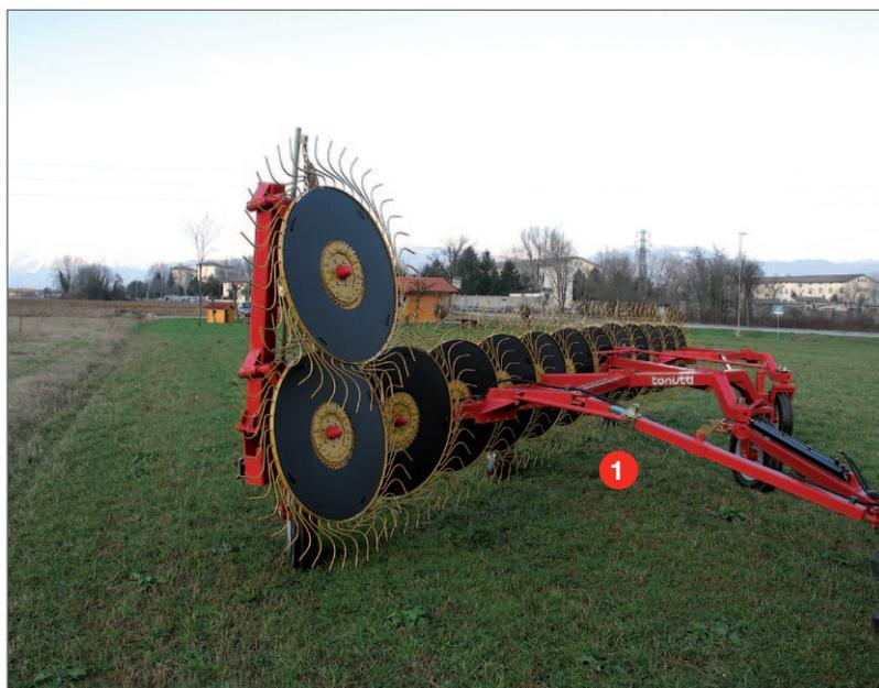
Pour les déplacements, un dispositif hydraulique permet de soulever les deux premiers disques soleil à l'avant en réduisant la longueur du râteau-faneur et en rendant la machine plus compacte.
